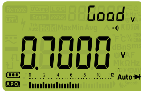
그림 2-22 자동 다이오드 표시 - 양호한 상태
