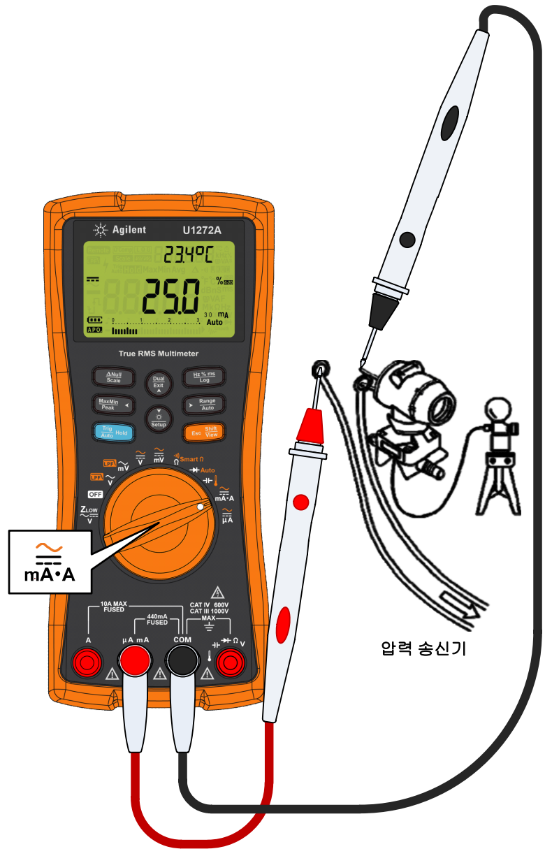
그림 2-34 4-20mA % 스케일을 사용해 dc 전류 측정
