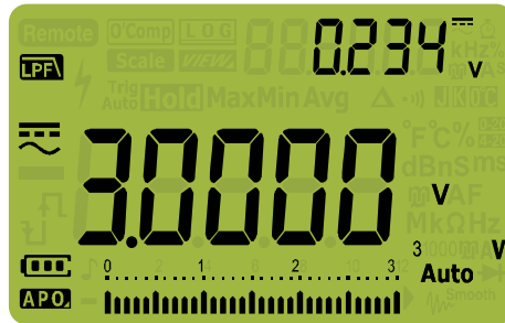
그림 2-4 ac+dc 전압 측정을 위한 DC 커플링
