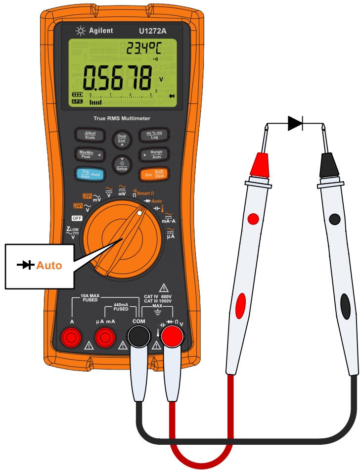
그림 2-20 순방향 바이어스 다이오드 테스트
