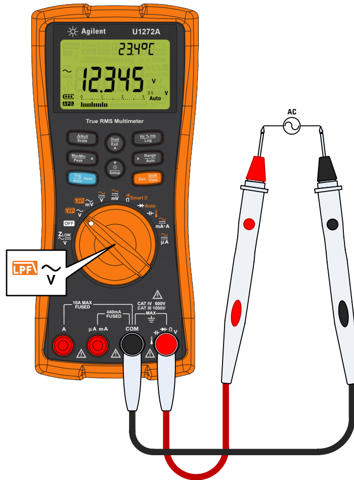
그림 2-2 ac 전압 측정
