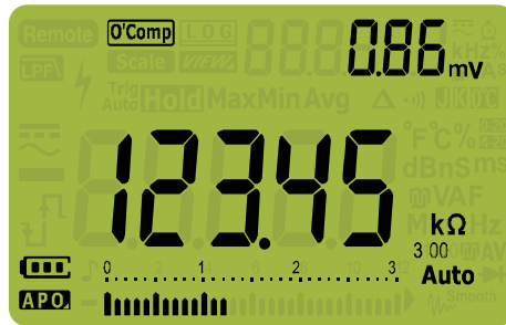
그림 2-16 Smart Ω( 바이어스 전압 포함 ) 표시
