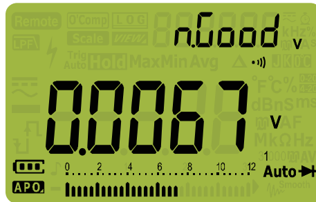
그림 2-23 자동 다이오드 표시 - 양호하지 않은 상태
